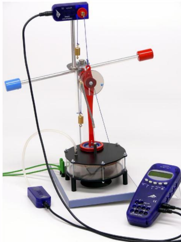
Fig. 8 Aufbau zur Aufzeichnung des Druck-Volumen-Diagramms
