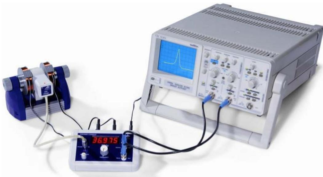
Fig. 5 Experimenteller Aufbau ESR mit einem Oszilloskop
