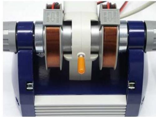
Fig. 4 Basiseinheit mit eingesteckter DPPH-
