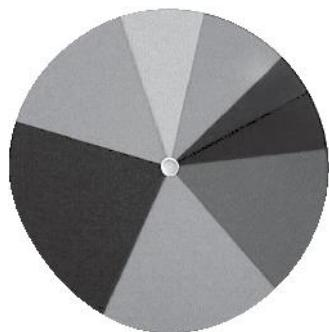
El disco de colores sirve para comprobar que, en la mezcla aditiva de colores, los colores del espectro se mezclan para formar el blanco.
