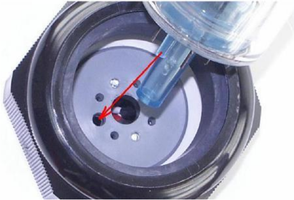
Fig. 1: Einsetzen der Röhre
